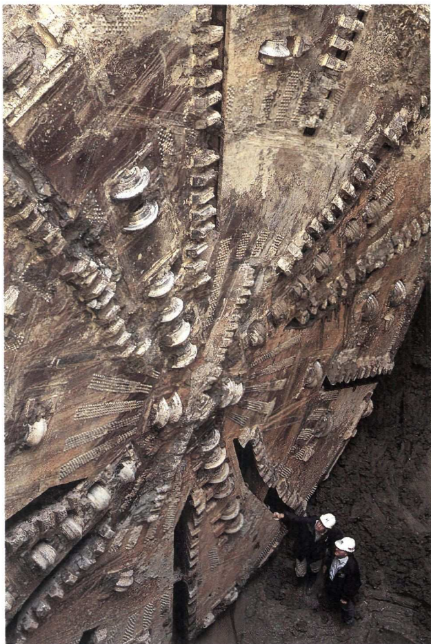
Le tunnelier utilisé pour le creusement de la nouvelle ligne de métro a permis des cadences moyennes de creusement de 10 mètres par jour.
