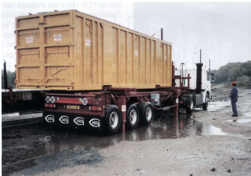
Transports de déchets ménagers entre Dunkerque et Fouquereuil : transfert de la caisse mobile du wagon sur le camion en gare de Fouquereuil avant transfert vers la décharge.
