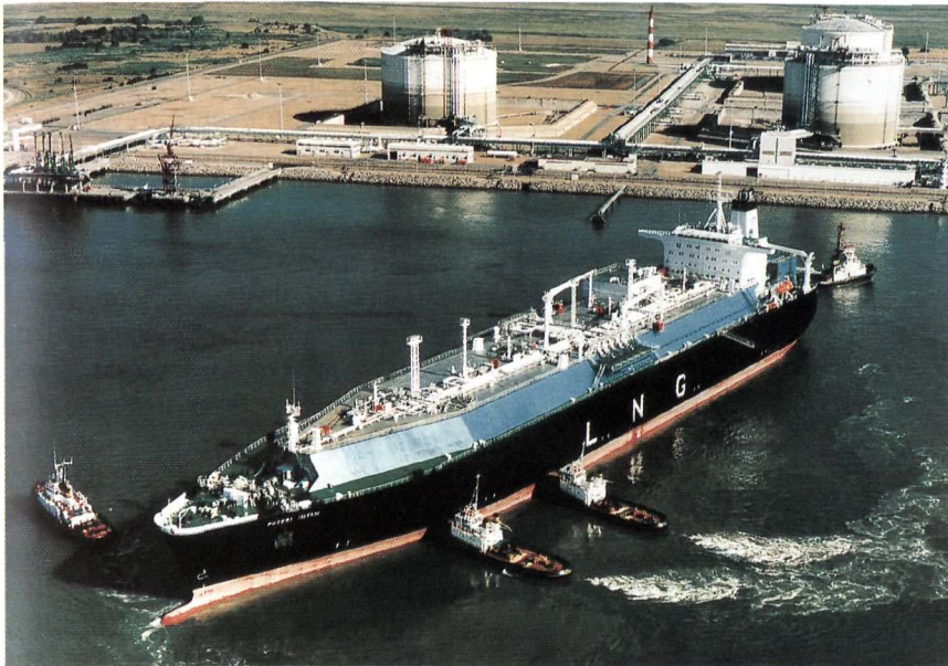
Méthanier sous licence GTT, 130 000 m 3 , pour Petronas (Malaisie).
