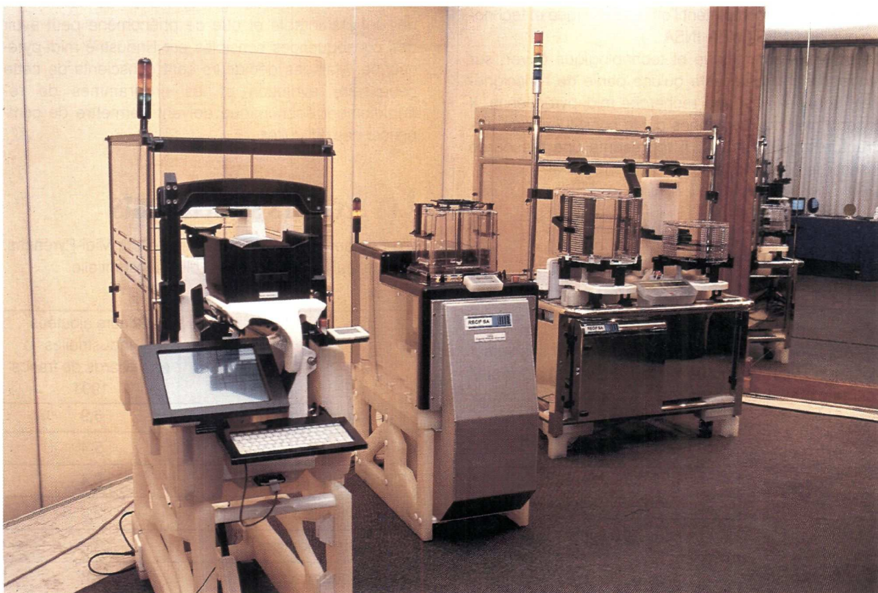
Robot réalisé par le CEA pour des mesures de rayonnement d'antennes (Groupe SEO).
