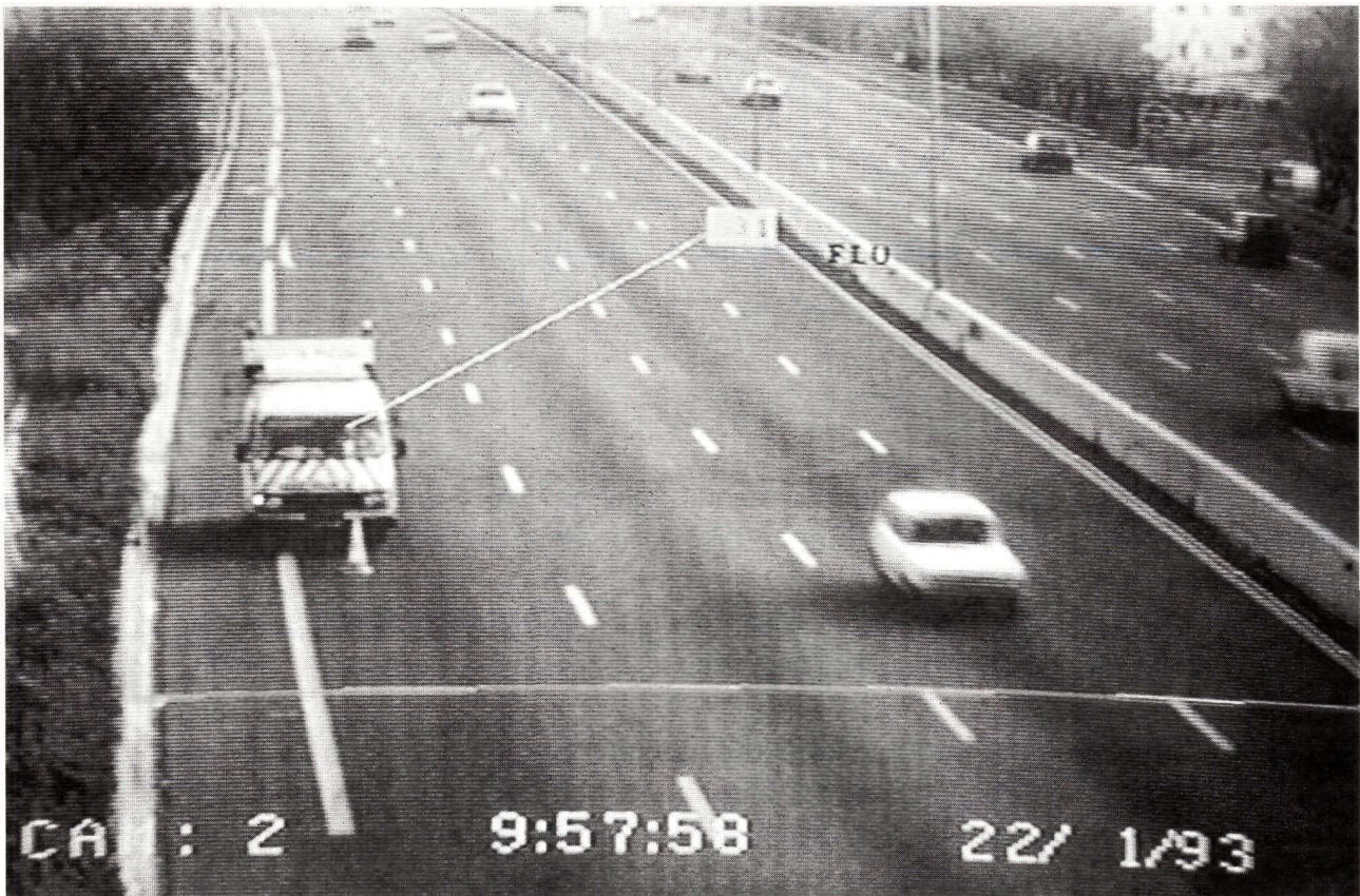
DAI - Détection Automatique d'Incident. (Crédit photo : Yannick Collet - ESCOTA).
