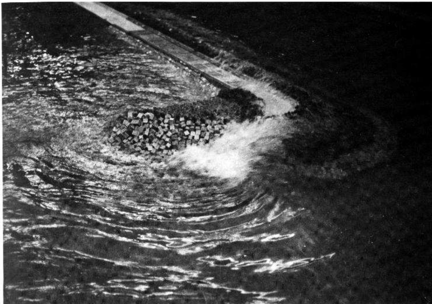
Modèle de stabilité au 1/88 e , digue de Mohammédia au Maroc. Essais en houle aléatoire. Type d'étude inaccessible aux modèles mathématiques pour le moment.
