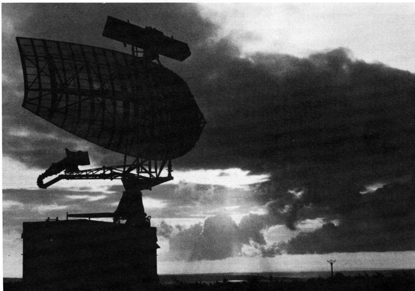
Radar d'aérodrome Thomson-CSF. Centaur pour le recueil des intercepteurs sur les terrains autonomes.
