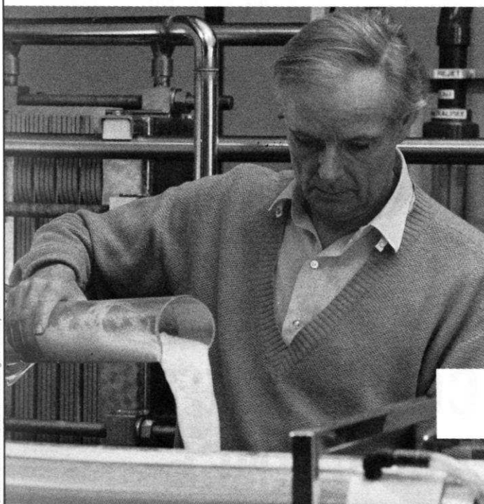
Concentration du lait par osmose inverse.
