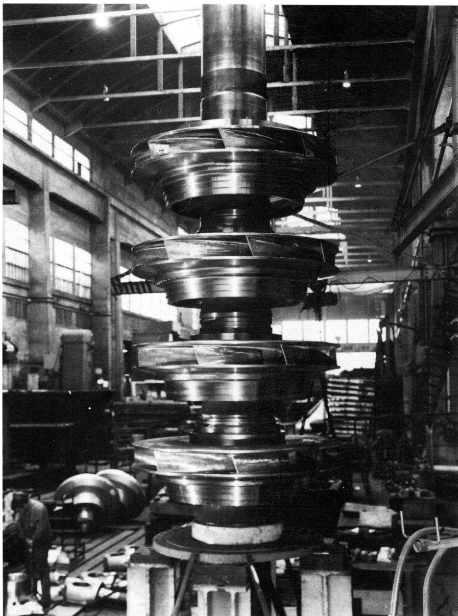
La Coche - Roues de turbine-pompe multiétage à ailettes fixes.
