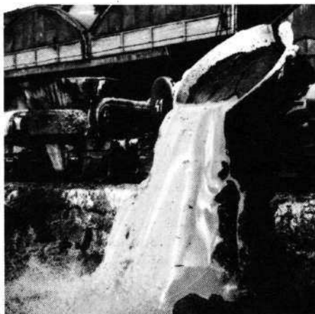
Coulée d'une poche de laitier
