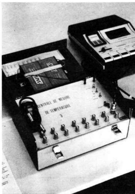
Acquisition de données (températures). Cet ensemble à 16 voies et à cadence lente d'acquisition permet de relever les températures sur les Ouvrages d'Art ou dans les Bâtiments. Il utilise comme support d'enregistrement des cassettes "audio" de faible coût.
