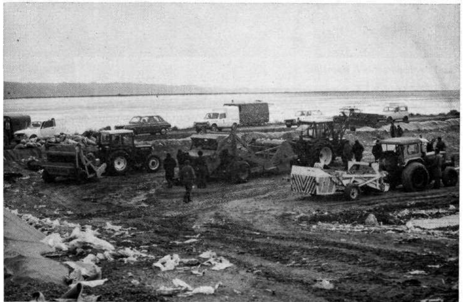
Essais systématiques de machines de nettoyage des plages pour récupérer le pétrole aggloméré. (Photo CEDRE)
