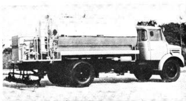
Equipement épandeur à transmission hydrostatatique et rampe à commande pneumatique
