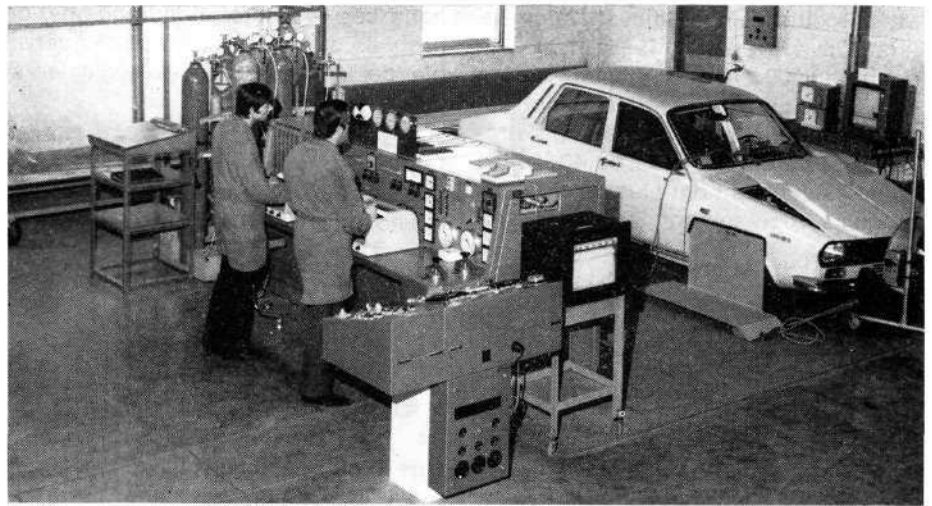
Installation de banc d'essai à rouleaux permettant la mesure précise de la consommation à différentes vitesses.
