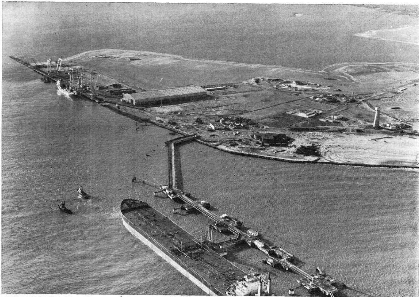
Photographie n° 1. — Vue aérienne du Verdon en janvier 1977. On remarque au premier plan le « Jade », pétrolier de 260 000 t de port en lourd, puis le terminal à conteneurs. En arrière de ces quais va être aménagée la première darse où seront mis en service plusieurs postes à marchandises diverses. L'amorce de la zone industrielle apparaît en haut à droite de la photo.
