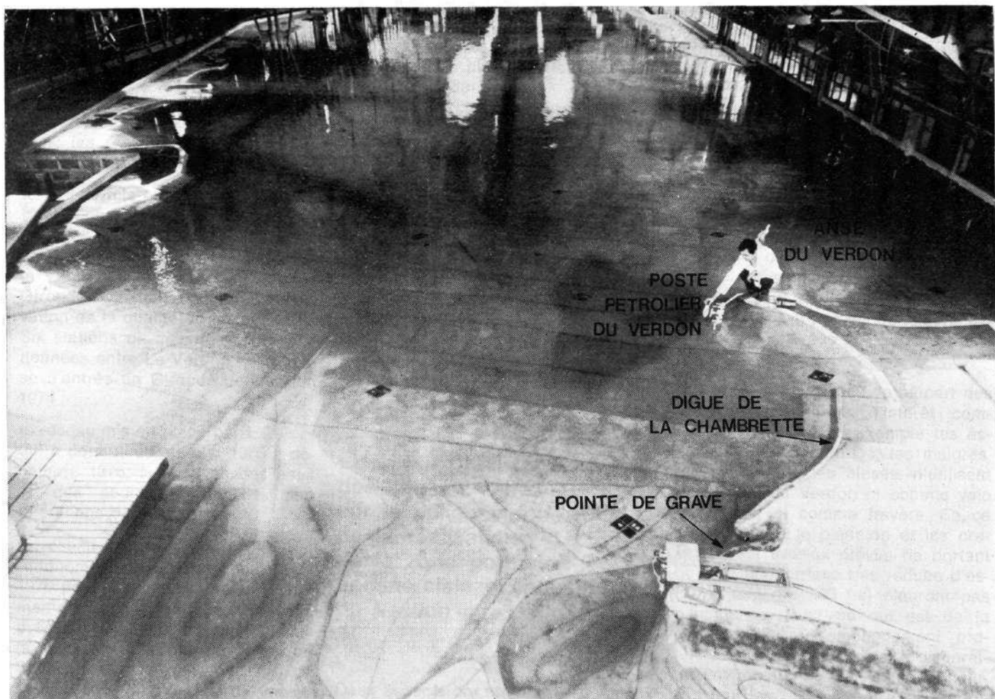
Modèle réduit de la partie aval de l'estuaire (échelle en plan 1/600).
