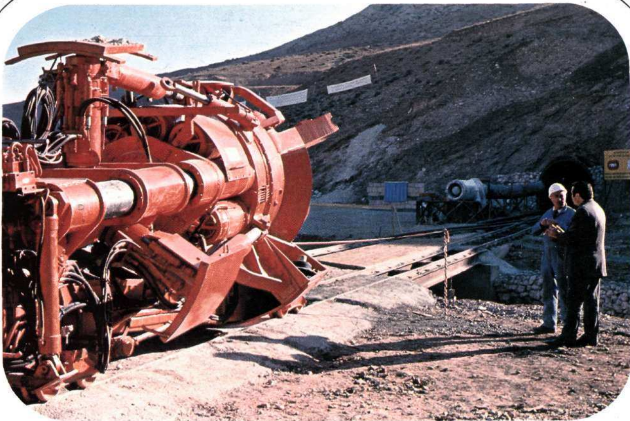
Tunnelier Bouygues entrant en galerie pour effectuer le percement d'un tunnel d'adduction d'eau à Damas (Syrie) Longueur : 17 km - Diamètre : 2,90 m
