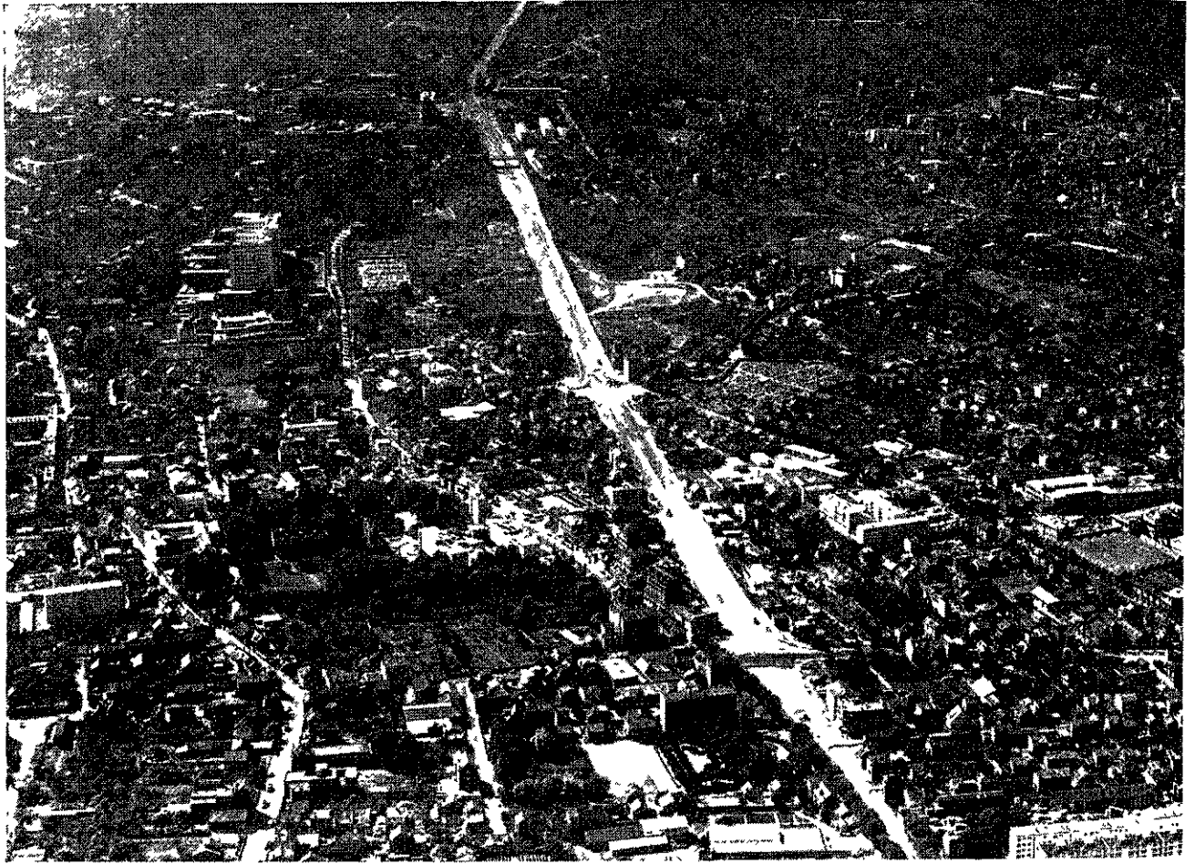
FIG. 3. — Déviation de la R.N. 306 à CHATILLON-SOUS-BAGNEUX . Le tracé général de la route est en fait rectifié par cette « déviation » (l'ancien tracé apparaît à gauche).
