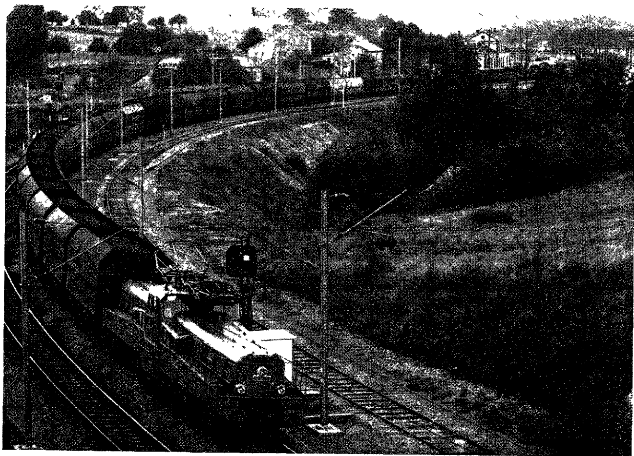
Fig. 5. — Les machines du record du monde d'aptitude au démarrage Un train de minerais de 1800 tonnes remorqué par une CC sur les lignes de l'Artère Nord-Est où les rampes atteignent une valeur de 11%.
